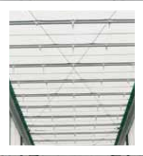
Натяжение по диагонали. Натяжение по диагонали на крыше для крепления груза в соответствии с EN12642 Code XL и для перевозки напитков. Имеющиеся как опция расширяющиеся резиновые вкладки снижают провисание стальных тросов во время открывания крыши.
