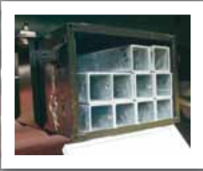
Закрытый контейнер для стоек. В закрытом контейнере для стоек, расположенном поперек шасси, стойки надежно защищены, как от воров, так и от загрязнений.
