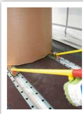
Направляющие. Стальные направляющие в сочетании с роллерами обеспечивают легкое перемещение бумажных рулонов. Высота подъема 20 мм также рассчитана для подкладки противоскользящих коврик.
