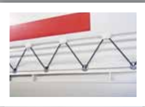
Запоры тента для бортовых прицепов. Тент с трапециями для расширительной резины (зигзагом); скобы тента в закрытом R-образном виде.
