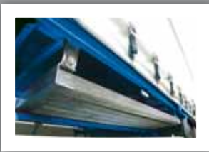
Открытый контейнер для стоек. В открытый контейнер под шасси можно положить не используемые вставные стойки.
