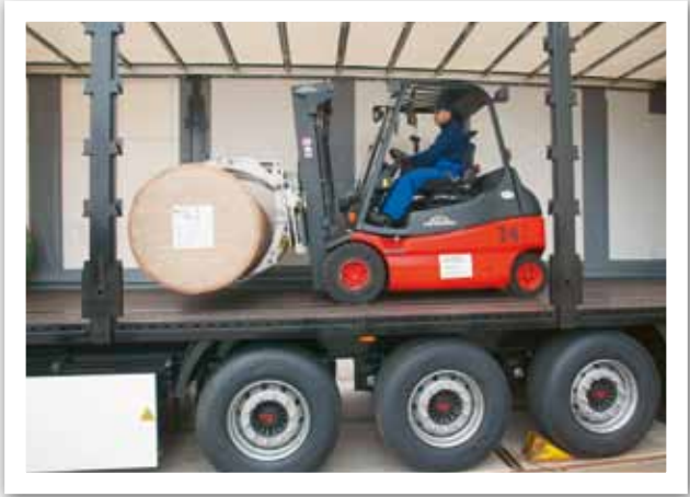
Прочное шасси. Уникальная, прочность шасси позволяет при погрузке/разгрузке использовать мощные автопогрузчики с осевой нагрузкой до 7 т.
