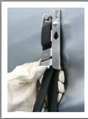
Альтернативные натяжные приспособления для сдвижных полотен. Натяжной замок с защелкой: требуется для перевозки по железной дороге. Автоматическое натяжное приспособление (с фиксатором или без): можно использовать при перевозках по железной дороге.
