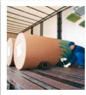
Многосторонняя стабильность роликов. Четыре ряда роликовых ходовых рельсов с интегрированными отверстиями для клиновидных стопоров фиксируют бумажные рулоны во всех вариантах.
