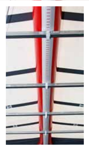
Безопасная крышка KRONE Safety Roof. Диагональная растяжка не требуется при использовании новой крыши KRONE Safety Roof, потому что при этом наружная балка имеет специальный элемент жесткости.
