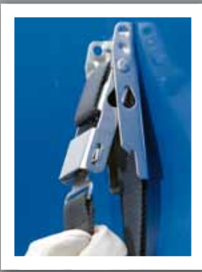
Альтернативные натяжные приспособления для сдвижных полотен. Натяжной замок с защелкой: требуется для перевозки по железной дороге. Автоматическое натяжное приспособление (с фиксатором или без): можно использовать при перевозках по железной дороге.
