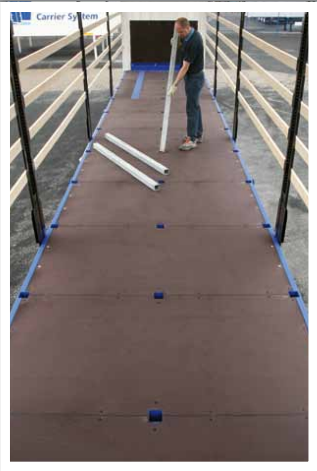
Закрепленные вставные стойки. Оцинкованные вставные стойки (80 x 80 мм) для соответствующих гнезд в полу прежде всего используются для крепления стальных рулонов.
