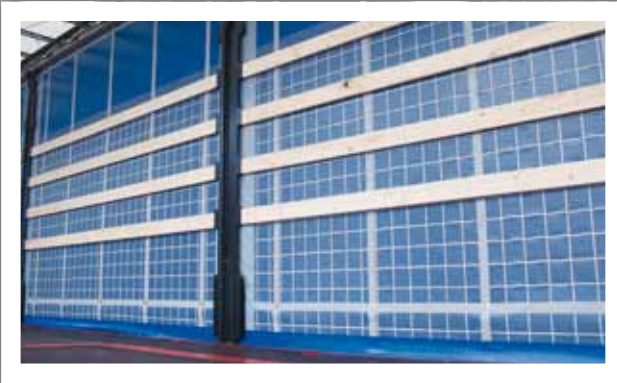
Защитный тент. Тенты для крепления грузов и защиты от кражи. Наваренные внутри стальные тросы крепят груз и защищают его от кражи. Возможны и другие модели.
