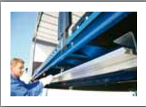
Практичный контейнер для реек. В контейнер для реек над шасси можно положить деревянные или алюминиевые рейки.
