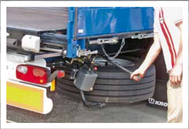
мм с каждой стороны). Пульт управления защищен и удобно расположен за осевым агрегатом. Для движения заднюю часть следует вернуть в исходное положение.
