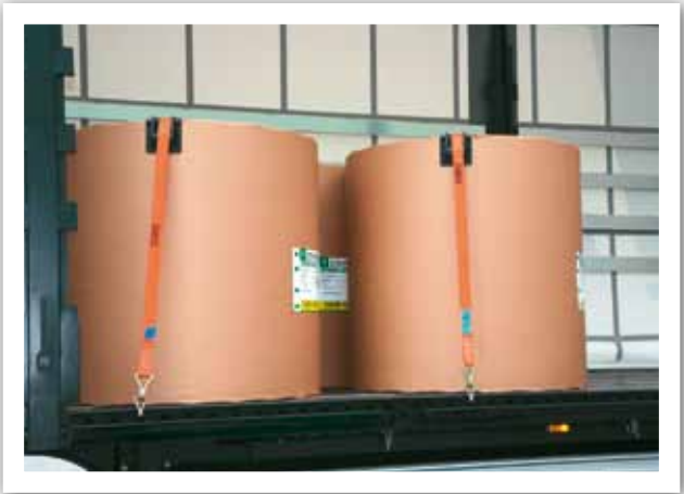
Отличное крепление бумажных рулонов. Специально для погрузки бумажных рулонов многозамковая внешняя рама с множеством точек крепления обеспечивает универсальные возможности крепления.
