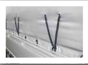
Плотный тент с трапециями для расширительной резины (зигзагом); скобы тента в закрытом R-образном виде.
