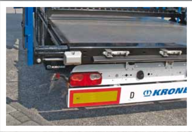
Закрепленные вставные стойки. Оцинкованные вставные стойки (80 x 80 мм) для соответствующих гнезд в полу прежде всего используются для крепления стальных рулонов.
